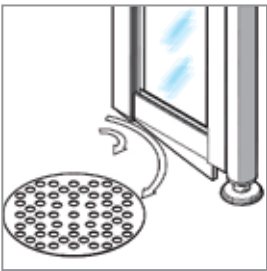
Lattiakaivo suihkutilan sisäpuolella
